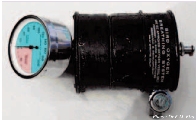
Fig. 6 : 1950, le premier prototype du Dr Bird avec sélection de la pression positive manuelle
