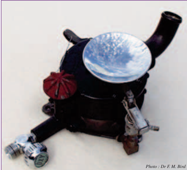
Fig. 2 : Premier appareil de pression mis au point par le Dr F.M. Bird
