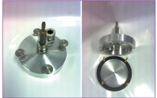
Figures 5 et 6 : Prototype de dispositif d'aérosolisation de spores par soufflage
