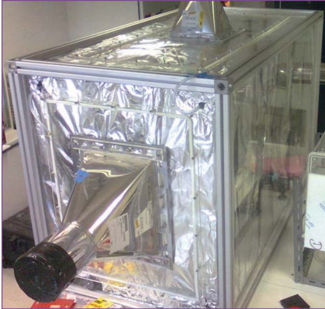
Figure 3 : Cuve en plexiglas utilisée au Laboratoire de Physique de l'ENS de Lyon pour y créer des aérosols fongiques.
