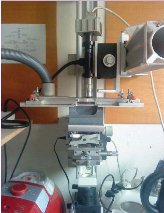
Figure 4 : Montage expérimental permettant de visualiser le ré-entrainement de particules à l'aide d'un microscope et d'une caméra rapide.
